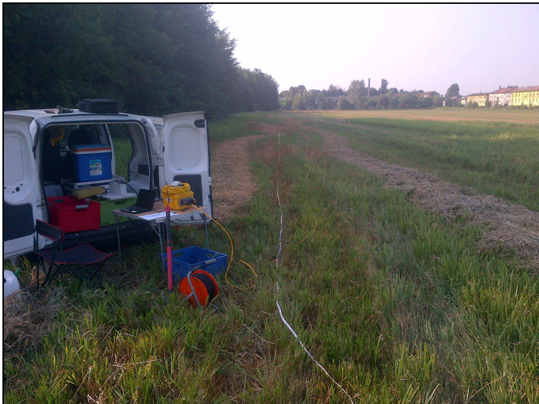
Figura 2: Vista dello stendimento MASW effettuato.
